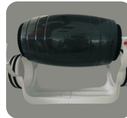
Verwijder de ventilatorbehuizing
