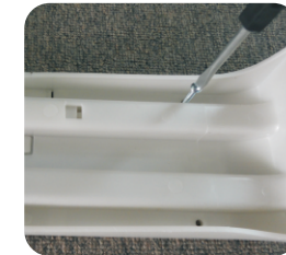
Bevestig de montagebeugel met schroeven
